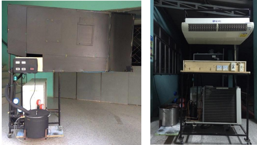
ภาพที่ 1 ระบบปรับอากาศที่ติดตั้งถังแลกเปลี่ยนความร้อน
