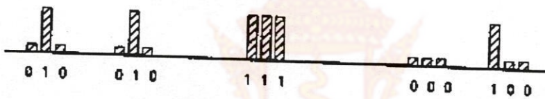
ภาพประกอบที่ 2.9 ค. การกำหนดรหัส (Code) ให้แต่ละพัลส์สัญญาณ
