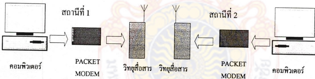
ภาพประกอบที่ 3.2 แนวนผังการรับ/ส่งข้อมูลระบบ PACKET RADIO
