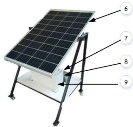
ภาพที่ 2 ตู้อบสมุนไพรใบพลูด้วยความร้อนจากฮีตเตอร์อินฟราเรดโดยใช้ไฟฟ้าจากโซลาร์เซลล์
