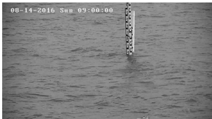
ภาพที่ 3 ตัวอย่างภาพบันทึกวิดีโอรายชั่วโมงเวลา 9.00 น. วันอาทิตย์ที่ 14 เดือนสิงหาคม 2559 อ่านค่าสเกลวัดที่ติดตั้งไว้กับเสาวัดระดับน้ำโดยตรงได้ 2.44 เมตร
