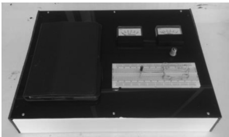
ภาพที่ 1 ชุดทดลองแบบปฏิสัมพันธ์เรื่องวงจรบริดจ์กระแสตรง
