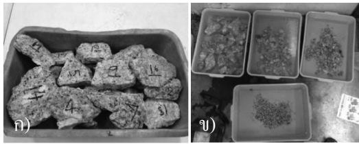
ภาพที่ 2 ตัวอย่างหินทดสอบ ก) แรงกดจุด และ ข) ความอยู่ตัวด้วยแมกนีเซียมซัลเฟต
