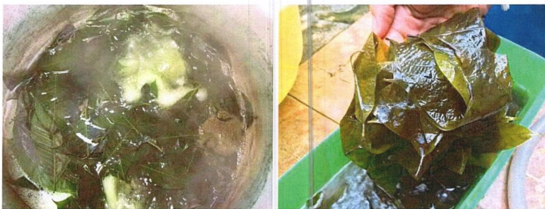
ภาพที่ 8 แสดงการนำใบยางพาราไปต้มในโซดาไฟ อัตราส่วนผสม น้ำ 5 ลิตร ต่อ โซดาไฟ 500 กรัม ใช้เวลาต้ม 3 ชั่วโมง ใช้อุณหภูมิในการต้มคงที่ 100 องศาเซลเซียส
