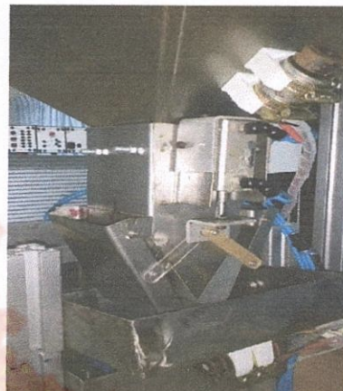
ภาพที่ 3-8 ส่วนลำเลียงหนังพลาสติกขาวปรุรงสระบบเปิด-ปิดถึงพักควบคุมด้วยกระบอกลูกสูบ
