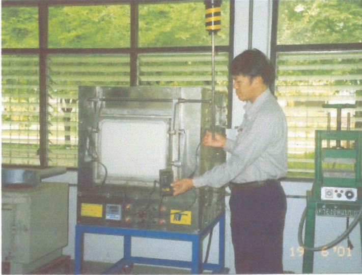
รูปที่ 17 แสดงการวัดอุณหภูมิภายใน และเปลือกเตาชั้นนอกสุด
