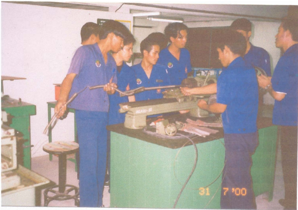
รูปที่ 11 แสดงการม้วนขดลวดความร้อน
