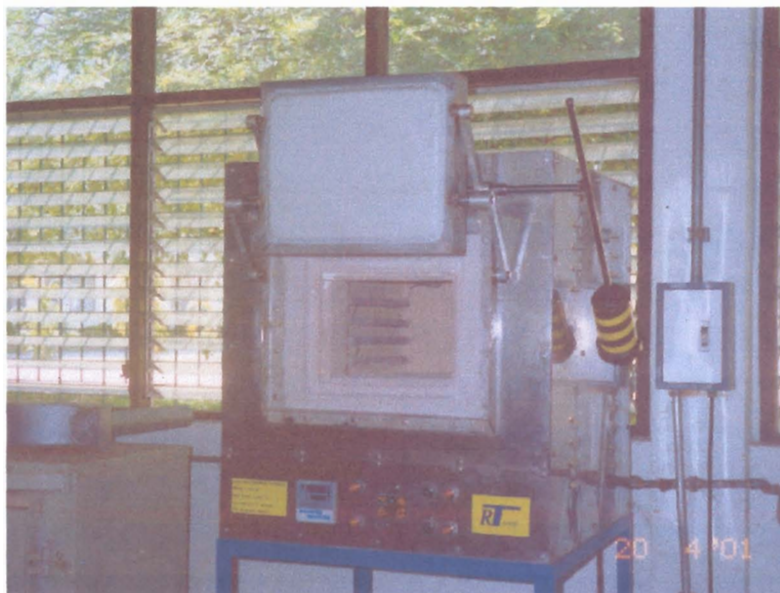
รูปที่ 10 แสดงการจัดวางชุดหลอด และระบบเปิด - ปิดประตูเตา
