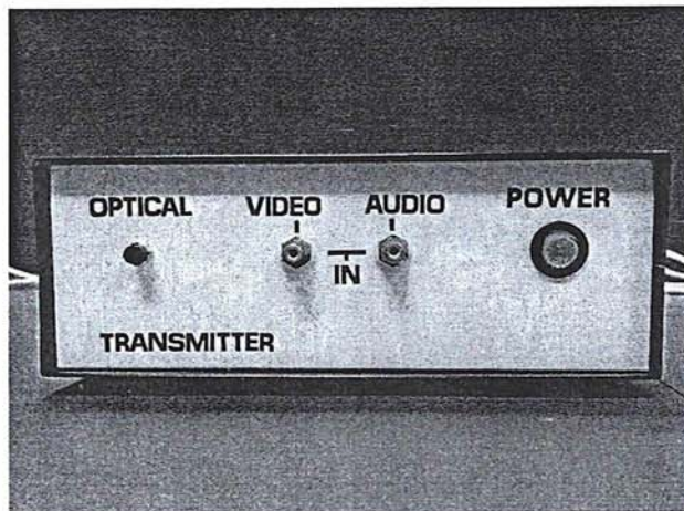
รูปที่ 3.12 ชุดส่งสัญญาณภาพและสัญญาณเสียงผ่านเส้นใยแก้วนำแสง
