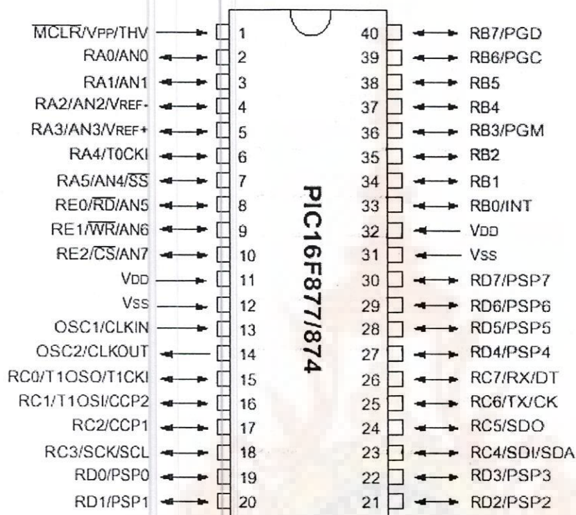
ภาพที่ 2-17 การจัดขาและคุณสมบัติทางเทคนิคของไมโครคอนโทรลเลอร์ PIC 16F877
