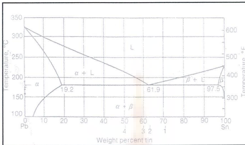
รูปที่ 2.14 แสดงแผนภาพสมดุลของตะกั่วและดีบุก [13]
