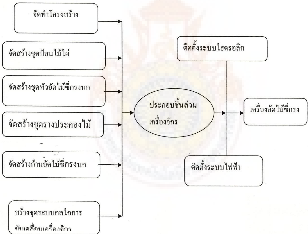
ภาพที่ 3.13 แสดงลำดับขั้นการจัดสร้างเครื่องอัดไม้ซึ่งกรงนก
