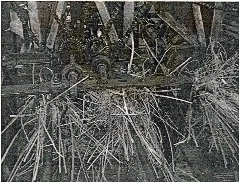
ภาพที่ 4.6 แสดงการทำงานของเครื่องตัดไม้ซี่กรงนกก
