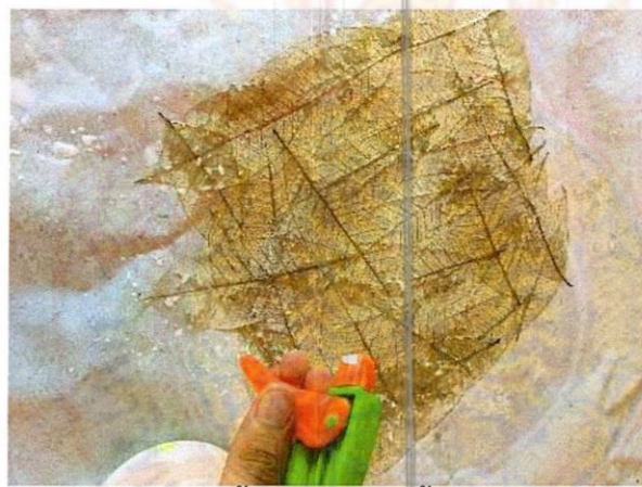
ภาพที่ 14 ขั้นตอนการพ่นน้ำยางพารา
