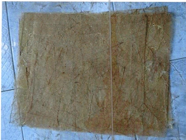
ภาพที่ 36 แสดงแผ่นใบยางที่ทำการตัดแต่งขอบ
