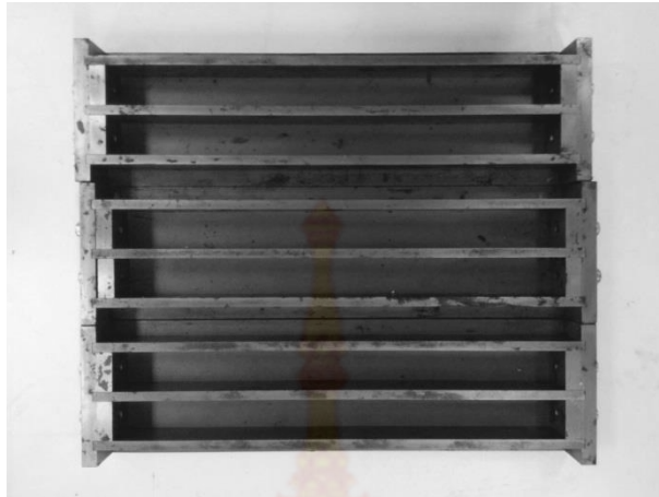
ภาพที่ 3-8 แสดงแบบหล่อชิ้นซีเมนต์เพสต์ ขนาด 25x25x28.5 มม
