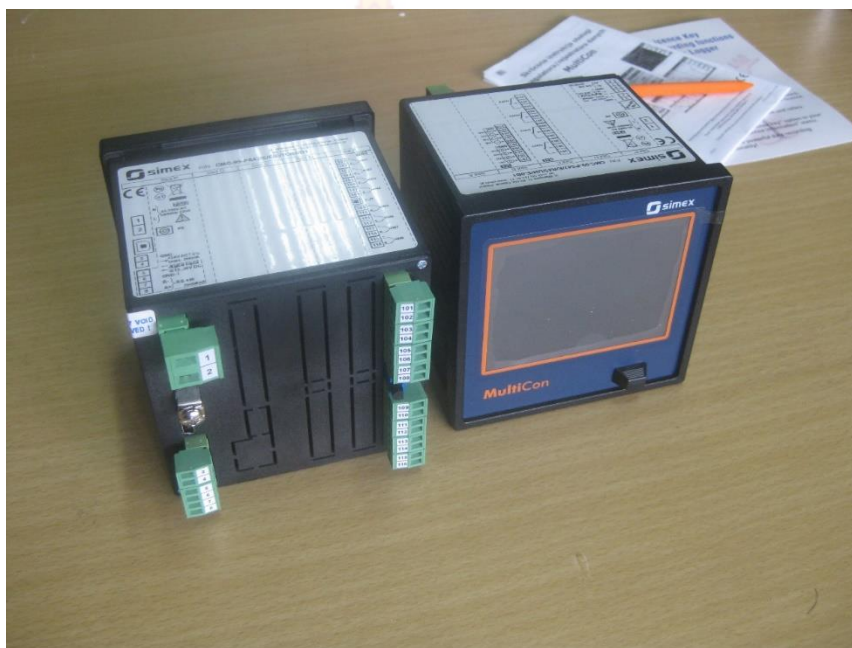
ภาพที่ 2.2 อุปกรณ์บันทึกข้อมูลอัตโนมัติใช้เก็บข้อมูลระยะยาว
