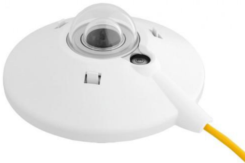
ภาพที่ 1.7 เครื่องวัดรังสีรวมแบบเทอร์โมไพล์ที่ผลิตโดยบริษัทคิปป์แอนด์โซเนนซ์ (เสริม, 2556)
