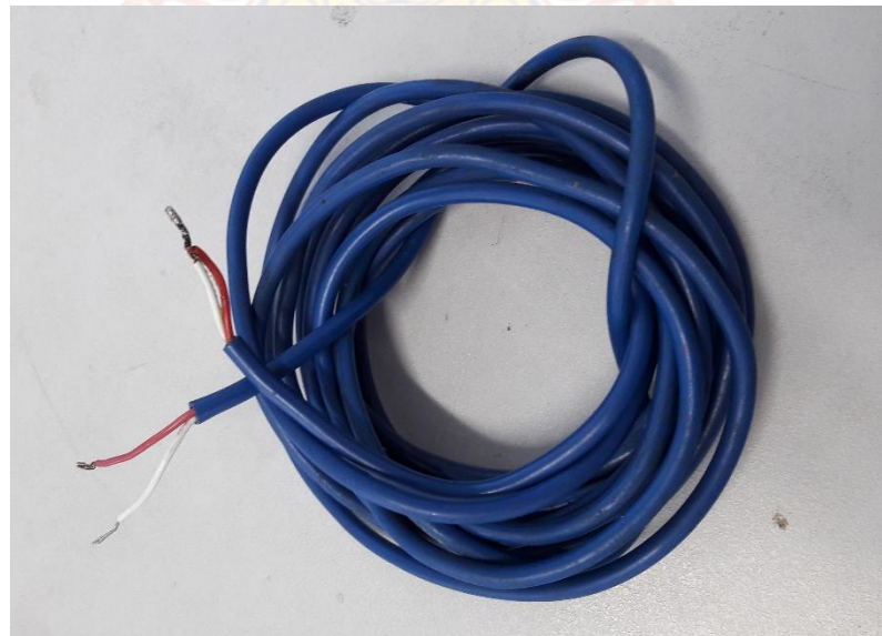
ภาพที่ 2.6 สายเทอร์โมคัปเปิ้ลสำหรับติดตั้งในบ่อเพื่อวัดอุณหภูมิของบ่อดิน
