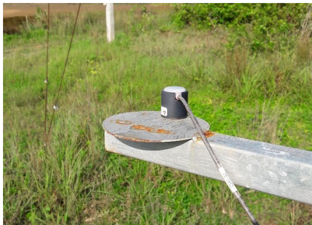
ภาพที่ 2.9 ติดตั้งเซนเซอร์วัดความชื้นของรังสีอาทิตย์ที่ระดับความสูง 2 เมตร
