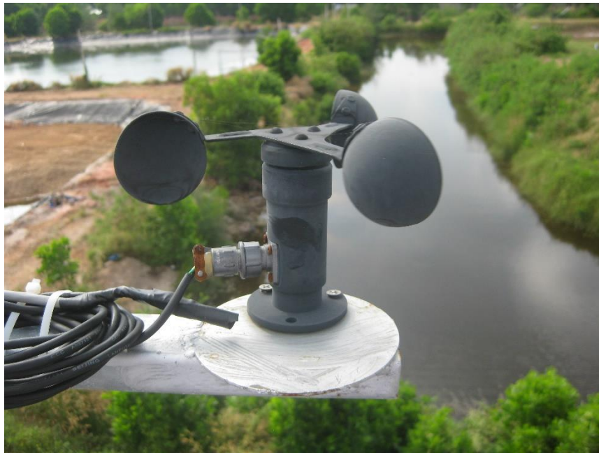
ภาพที่ 2.5 เซนเซอร์วัดอัตราเร็วลมติดตั้งที่ระดับความสูง 10 เมตร
