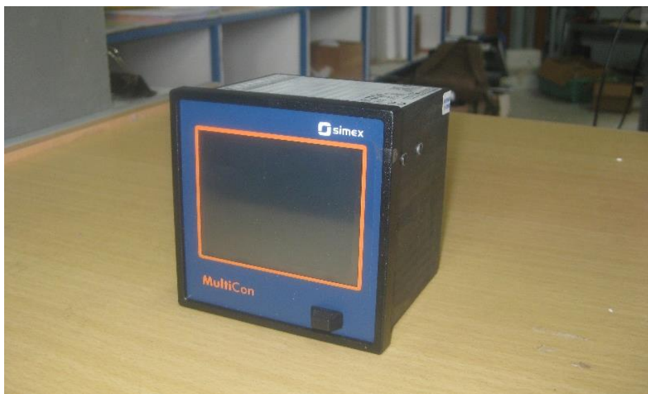
ภาพที่ 1.10 เครื่องบันทึกข้อมูลเชิงตัวเลข
