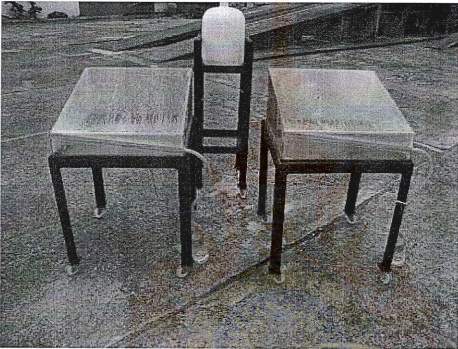
รูปที่ 2.4 เครื่องกลั่นน้ำทะเลด้วยพลังงานแสงอาทิตย์ที่มีถาดรองน้ำแบบเรียบ และ แบบลอนสี่เหลี่ยม [5]
