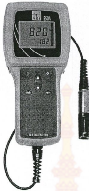
รูปที่ 4.7 เครื่องวัดปริมาณออกซิเจนในน้ำแบบภาคสนาม
