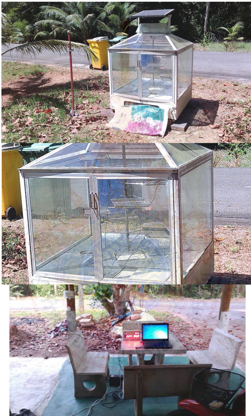
ภาพผนวกที่ 4 ตำแหน่งติดตั้งชุดวัดอุณหภูมิและความชื้นของเครื่องอบแห้งเอนกประสงค์ แบบหมุนพลังงานแสงอาทิตย์ที่ใช้เก็บข้อมูล
