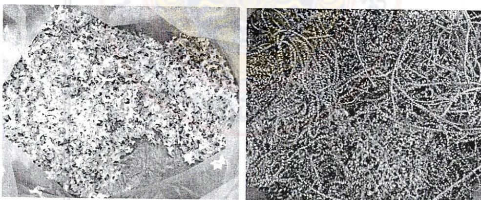
ภาพที่ 3.13 เศษโลหะผสมอะลูมิเนียมที่ใช้ในการหลอมเพื่อทดสอบเตา
