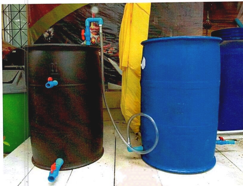
รูปที่ 3.7 การเชื่อมถังผลิตก๊าซชีวภาพกับถังเก็บก๊าซชีวภาพ
