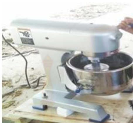
ภาพที่ 3-1 การผสมวัสดุดิบและวัสดุประสานในอัตราส่วนต่าง ๆ ด้วยเครื่องผสมอัตโนมัติ
