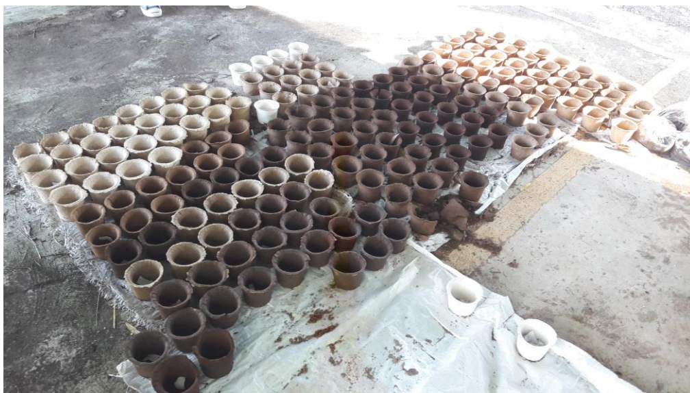
ภาพที่ 3-4 ตัวอย่างกระถางที่อัดขึ้นรูปได้
