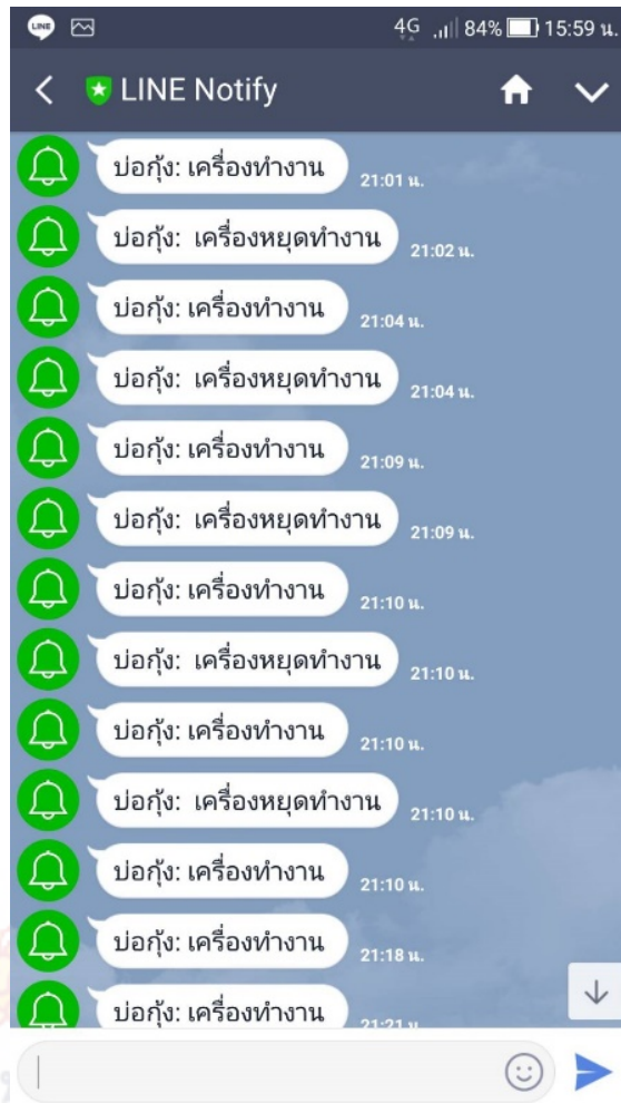
ภาพที่ 3 – 29 ระบบแจ้งเตือนการทำงานของชุดอุปกรณ์ควบคุมปริมาณตะกอนผ่านแอปพลิเคชันไลน์
