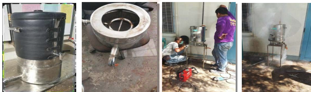
รูปที่ 3.11 ขั้นตอนกระบวนการจัดทำหม้อต้มน้ำร้อนไอน้ำ
