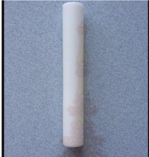
ภาพภาคผนวกที่ 1 แท่งเทปลอน(ขนาด D=8\text{mm} \times 100\text{ mm} , d_1=2\text{ mm} , d_2=6\text{mm} )
