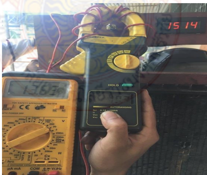
ภาพที่ 2.10 แสดงการวัดด้วยโวลต์มิเตอร์แบบดิจิตอลและแคลลมมิเตอร์
