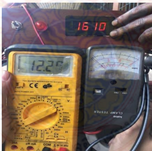
ภาพที่ 2.8 แสดงการวัดค่าด้วยโวลต์มิเตอร์
