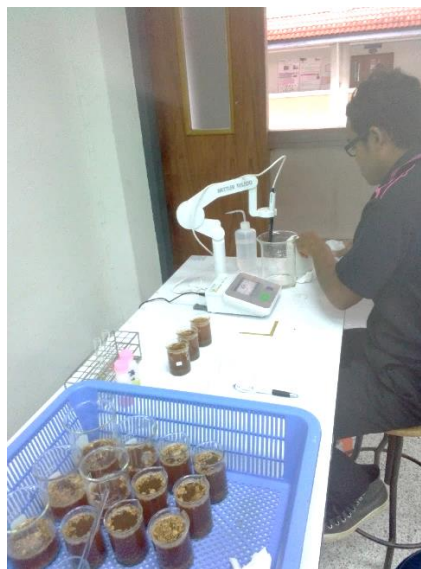
การวัดค่าพีเอชของปุ๋ยอินทรีย์จากก้อนเชื้อเห็ดนางฟ้าเหลือทิ้ง
