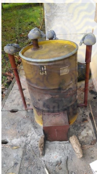
ภาพที่ 1.6 การปิดปล่องทุกปล่อง และปิดหน้าเตา
