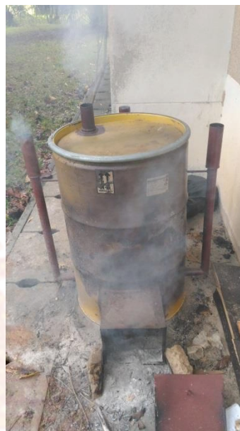
เปิดหน้าเตา เพื่อให้อากาศเข้าไปทำปฏิกิริยากับถ่าน
