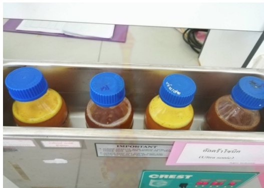
ภาพผนวกที่ 4 ตัวอย่างไขมันชั้นและขำลิงที่สกัดด้วยวิธีอัลตราซาวด์เสริม
