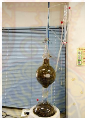
ภาพที่ 2.3 วิธีสกัดน้ำมันหอมระเหยโดยการกลั่นด้วยน้ำและไอน้ำ
