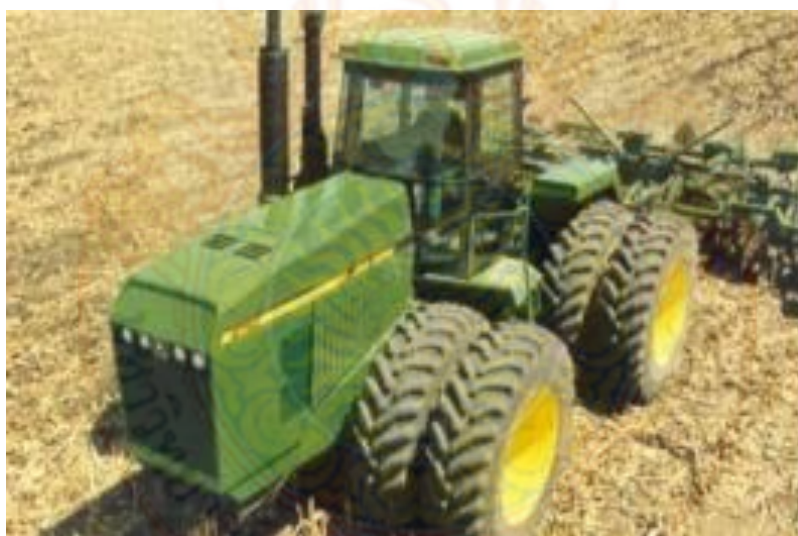
รูปที่ 2.15 แทรกเตอร์ขับเคลื่อนชนิด 4 ล้อจริง (ที่มา: http://pirun.kps.ku.ac.th )
