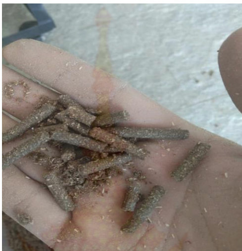
รูปที่ 3.6 วัสดุที่บอกจากเครื่องอัดเชื้อเพลิงชีวมวล
