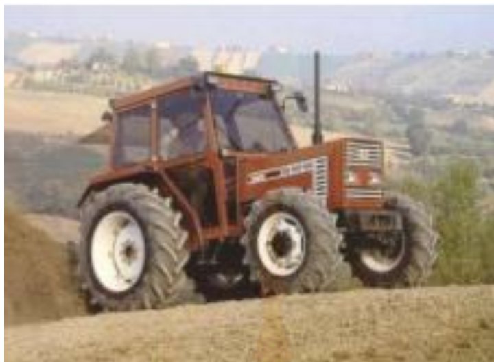
รูปที่ 2.14 แทรกเตอร์ชนิด 4 ล้อ โดยที่ล้อหน้าเป็นล้อช่วย (ที่มา: http://pirun.kps.ku.ac.th )
