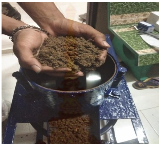
รูปที่ 3.4 นำชีวมวลใส่ในเครื่องอัดเม็ดชีวมวล
