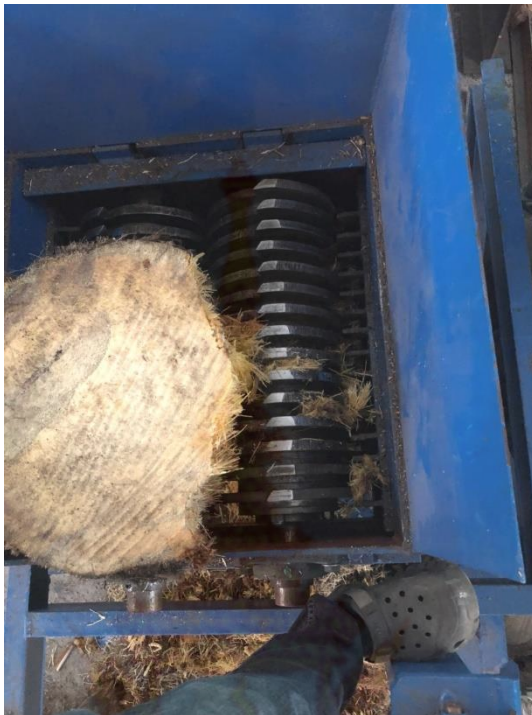
ภาพที่ 3 การบดสับต้นปาล์มหมดอายุ
