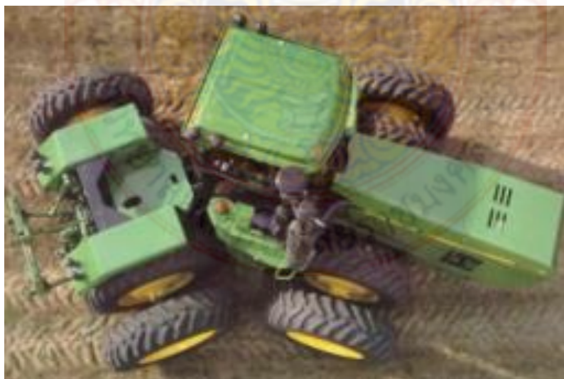
รูปที่ 2.17 การหันเลี้ยวของแทรกเตอร์ชนิดขับเคลื่อน 4 ล้อ
