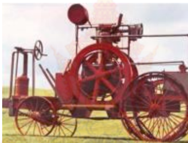
รูปที่ 2.5 แทรกเตอร์คันแรกที่ใช้เครื่องยนต์เผาไหม้ภายใน (ที่มา: http://pirun.kps.ku.ac.th )
