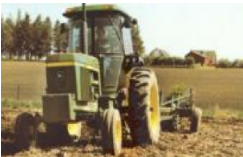
รูปที่ 2.9 แทรกเตอร์ชนิด 4 ล้อ ขับเคลื่อนล้อหลังแบบมาตรฐาน
