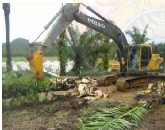
รูปที่ 2.2 การโค่นล้มต้นปาล์มโดยวิธีการใช้เครื่องจักรล้มและหันต้นปาล์ม (โครงการผลิตปาล์มน้ำมันและน้ำมันปาล์มเพื่อพลังงานชีวภาพอย่างยั่งยืน, 2553)
