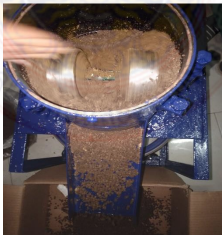
รูปที่ 3.5 การทำงานของเครื่องอัดชีวมวล
