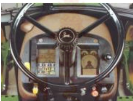
รูปที่ 2.20 แผงหน้าปัทม์ควบคุมด้วยระบบอิเล็กทรอนิกส์ของแทรกเตอร์ในปัจจุบัน (ที่มา: http://pirun.kps.ku.ac.th )
