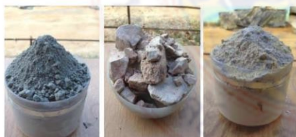
ภาพที่ 1 ลักษณะสีของปูนซีเมนต์ปอร์ตแลนด์, หินผุก่อนที่จะนำมาบดและหินที่บดเป็นฝุ่นหินผุแล้ว
