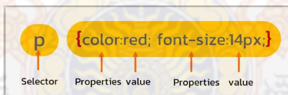
ภาพที่ 2-2 ส่วนประกอบของโครงสร้างของ CSS
