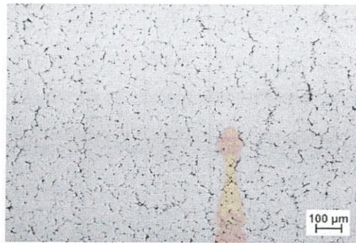
ภาพที่ 4.5 โครงสร้างจุลภาคของอะลูมิเนียมเกรด 5083 ที่ขึ้นรูปด้วยการหล่ออัดแบบน้ำโลหะทั่วไป
