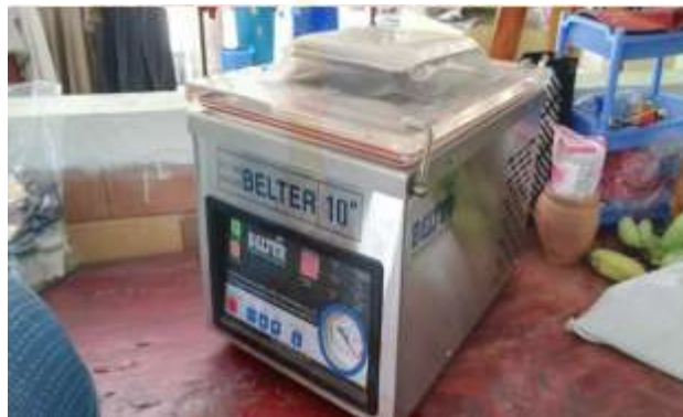
ภาพที่ 4.6 แสดงเครื่องบรรจุแบบสุญญากาศ
