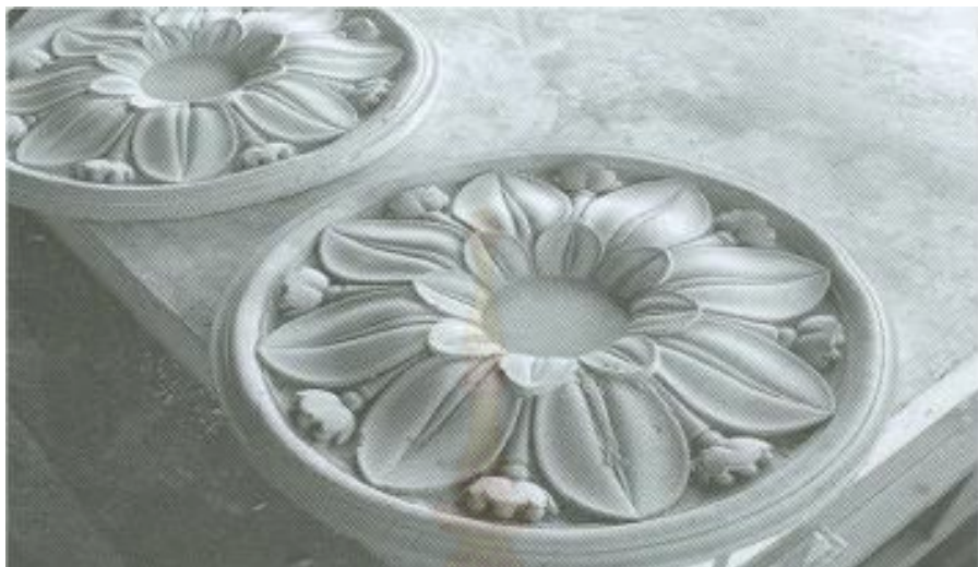
ภาพที่ 4 ผลิตภัณฑ์ที่ได้จาก Working mold ที่เสื่อมสภาพของอุตสาหกรรมเซรามิกส์ ที่มา : เกรียงศักดิ์ เขียวมั่ง (2549)
