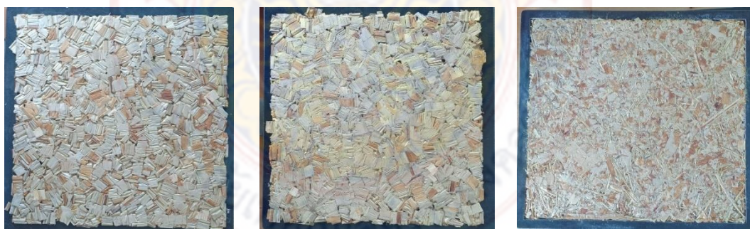
ภาพที่ 23 แผ่นผนังจากเศษต้นจาก, (ก) แผ่นผนังจากเศษต้นจากขนาดเดียวไม่ใส่พาราฟิน, (ข) แผ่นผนังจากเศษต้นจากขนาดเดียวใส่พาราฟิน และ (ค) แผ่นผนังจากเศษต้นจากคละขนาดใส่พาราฟิน) โดยทำการศึกษาเพิ่มเติม โดย
