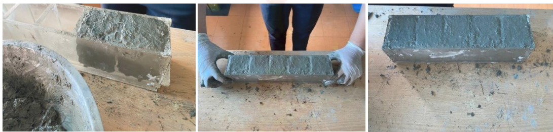
รูปแบบการใส่ส่วนผสมลงในโม่ลดอะคริลิก ขนาด ขนาด 50 มม. x 50 มม. x 50 มม.
