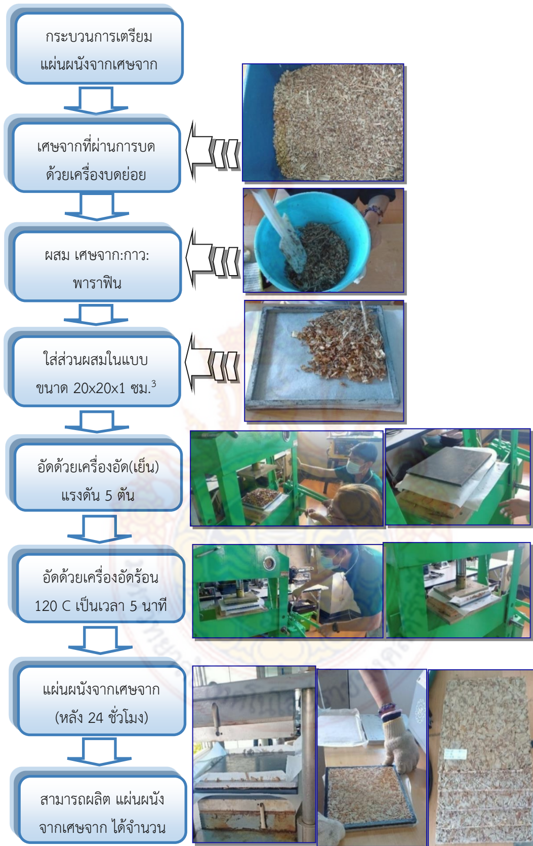
ภาพที่ 25 แสดงกระบวนการเตรียมแผ่นผนังจากเศษจาก
