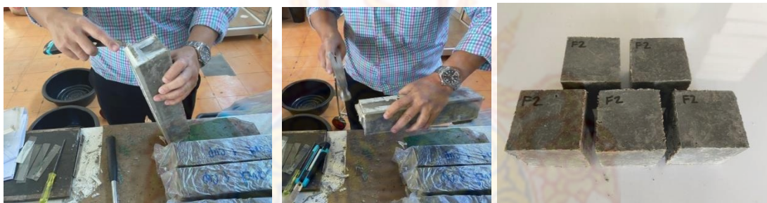
รูปแบบการใส่ส่วนผสมลงในโม่ลดอะคริลิก ขนาด ขนาด 50 มม. x 50 มม. x 50 มม.
