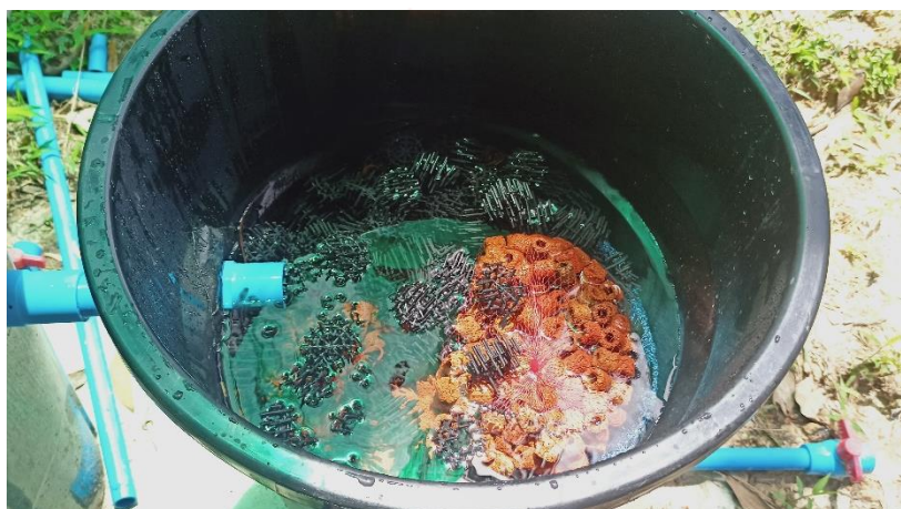
ภาพที่ 3.11 วัสดุกรองสำหรับระบบบำบัดน้ำในบ่อหอย
