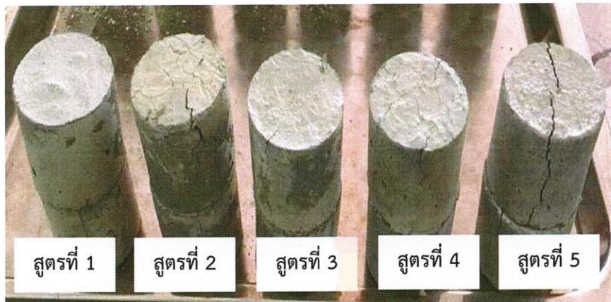
ภาพที่ 4.12 ผลการทดสอบการทนความร้อนของตัวเตาประหยัดพลังงาน ที่อุณหภูมิ 600 °C เป็นเวลา 30 min
