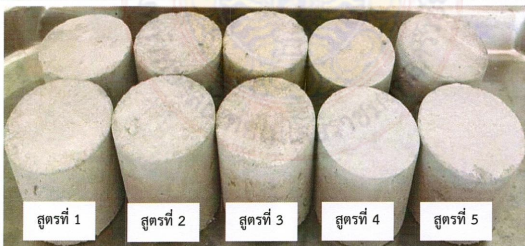
ภาพที่ 4.15 อัตราส่วนผสมสำหรับการขึ้นรูปของเตาประหยัดพลังงาน ระหว่างปูนซีเมนต์ตราเสือ : ทรายหยาบ : หิน
