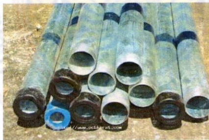
ภาพที่ 3.7 ท่อดูดอากาศของเตาประหยัดพลังงาน
