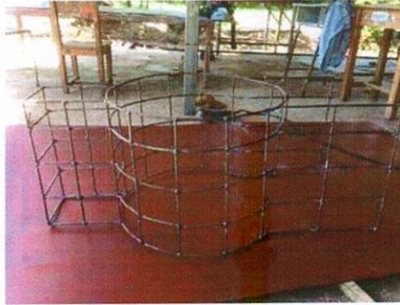
ภาพที่ 3.8 แบบโครงสร้างเหล็กของตัวเตาประหยัดพลังงาน
