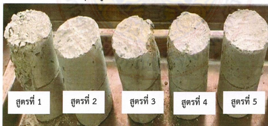
ภาพที่ 4.17 ผลการทดสอบการทนความร้อนของตัวเตาประหยัดพลังงาน ที่อุณหภูมิ 800 °C เป็นเวลา 20 min
