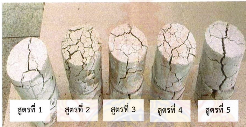
ภาพที่ 4.13 ผลการทดสอบการทนความร้อนของตัวเตาประหยัดพลังงาน ที่อุณหภูมิ 800 °C เป็นเวลา 20 min
