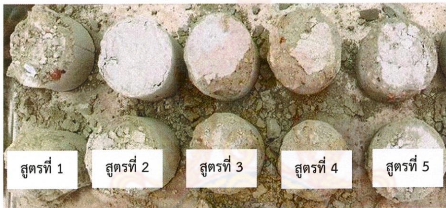
ภาพที่ 4.19 ผลการทดสอบการทนความร้อนของตัวเตาประหยัดพลังงาน ที่อุณหภูมิ 800 °C เป็นเวลา 60 min
