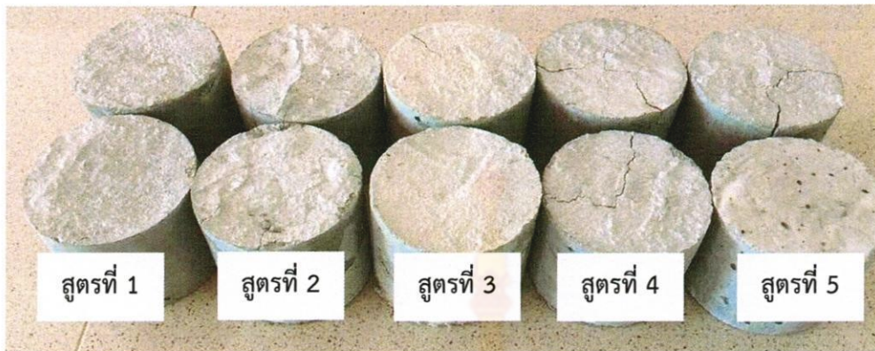
ภาพที่ 4.11 อัตราส่วนผสมสำหรับการขึ้นรูปของเตาประหยัดพลังงาน ระหว่างปูนซีเมนต์ : ทราย : หิน
