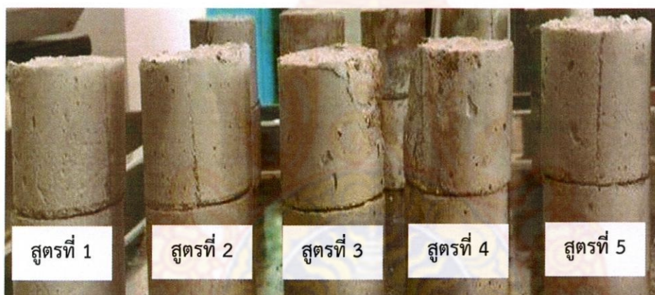
ภาพที่ 4.16 ผลการทดสอบการทนความร้อนของตัวเตาประหยัดพลังงาน ที่อุณหภูมิ 800 °C เป็นเวลา 10 min
