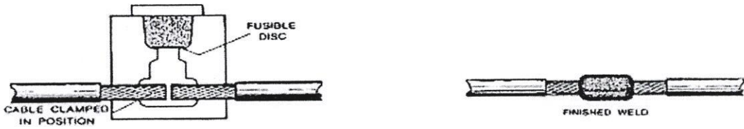
รูปที่ 2.6 การเชื่อมประสานแบบ Cad Welding
