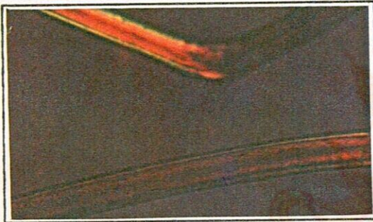
ภาพ 4-34 ภาพตามยาวและภาพตามขวาง โยอะคริลิก-ออร์ลอน
