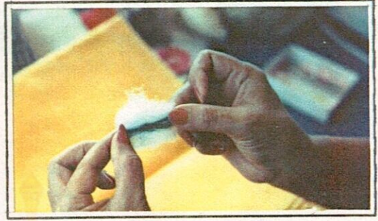
(2) คลายเกลียวเส้นด้าย ดึงเส้นใยออกเป็นเส้น ๆ แล้วเรียงเส้นใยลงบนแผ่นสำลี
